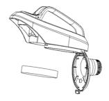
Снимите крышку и извлеките из нее фильтр.
