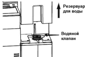
Снимите резервуар для воды.
