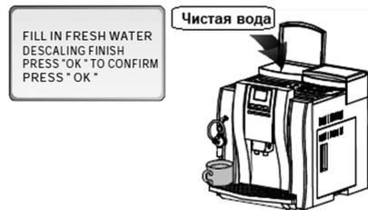
Когда кофемашина закончит очистку (обычно на это требуется 60 минут) и на дисплее отобразится индикация, означающая, что резервуар для воды пуст, снимите резервуар и наполните его чистой водой до максимальной отметки. Установите резервуар в кофемашину и нажмите кнопку ОК. Кофемашина перейдет в режим промывки, при этом на дисплее должна отобразиться индикация «RINSING».
