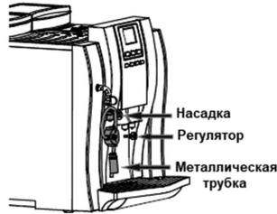
Отсоедините металлическую трубку подачи горячей воды. Для снятия насадки используйте ключ на мерной ложке.
