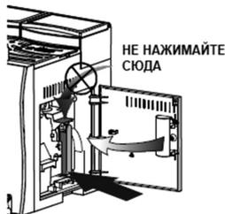
Возьмите варочный блок за ручку и задвиньте его на его посадочное место.
