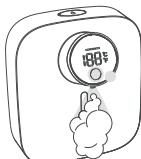
Поднесите руку ладонью вверх под датчик, и из отверстия диспенсера выделится мыльная пена.
