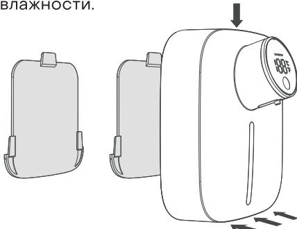
Зафиксируйте на стене кронштейн, затем наденьте на него корпус прибора.
