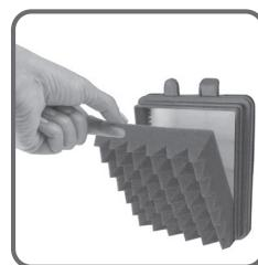
Регулярно проводите чистку фильтров защиты двигателя (20 и 21). Губчатый фильтр (21) и фильтр защиты двигателя (20) можно мыть водой. Оба фильтра нужно менять ежегодно.
