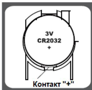
Чтобы заменить разрядившуюся батарейку, откройте крышку отсека для батарейки на обратной стороне весов, нажав на рычажок. Нажмите на батарейку, и она разблокируется. Вставьте новую батарейку знаком «+» вверх под контакт и прижмите. Закройте крышку отсека для батарей.
