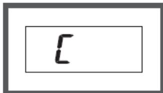
Если во время определения веса произошла ошибка, на дисплее отобразится индикатор «С». В этом случае следует повторить взвешивание.
