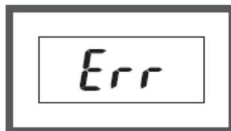
Индикатор перегрузки сообщает о превышении допустимой нагрузки. При появлении этого индикатора немедленно сойдите с весов, чтобы не допустить их повреждения.
