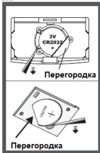
Чтобы заменить разрядившуюся батарейку, откройте крышку отсека для батарейки на обратной стороне весов, нажав на рычажок. Затем извлеките старую батарейку, при необходимости используйте острый предмет. Установите батарейку знаком «+» вверх. Закройте крышку отсека для батарей.
