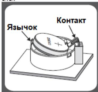
Чтобы заменить разрядившуюся батарейку, откройте крышку отсека для батарейки на обратной стороне весов, нажав на рычажок. Нажмите на черный язычок назад, и батарейка разблокируется. Вставьте новую батарейку знаком «+» вверх под контакт и прижмите. Закройте крышку отсека для батарей.
