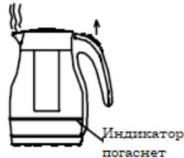
Когда вода вскипит, чайник автоматически выключится, и индикатор погаснет. Чайник также выключается при снятии с подставки.
