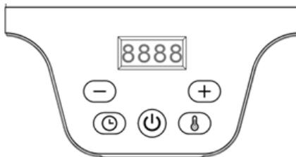
На панели управления располагается дисплей, на котором во время работы прибора отображается текущая температура или установленное время таймера, а также пять кнопок управления:
