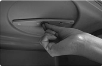
Зафиксируйте верхнее коромысло-разбрызгиватель, вкрутив пластиковый болт против часовой стрелки.
