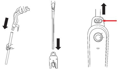
Выровняйте ручку и удлинительную трубку и вставьте с небольшим усилием ручку в трубку. Должен раздаваться легкий щелчок.
