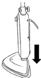
Выверните ручку относительно удлинительной трубки и вставьте трубку в ручку. Прижмите до фиксации.
