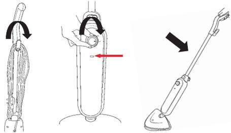
Поверните крючок на ручке, чтобы быстро снять шнур питания.
