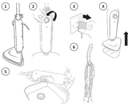
По окончании использования выключите швабру переключателем питания, вернув его в положение **OFF**, отключите прибор от электросети и дайте ему остыть.
