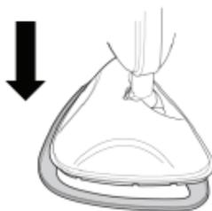
Для уборки ковров можно дополнительно установить специальную насадку, которая поможет эффективнее освежить и очистить их ворс. Расположите швабру над насадкой для чистки ковров, выровняйте головку относительно насадки, а затем опустите. Насадка для чистки ковров не фиксируется на головке, швабра просто стоит на насадке. Чтобы снять насадку для чистки ковров, просто поднимите швабру.
