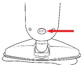
Чтобы отсоединить головку швабры, нажмите на кнопку снятия головки и снимите ее.
