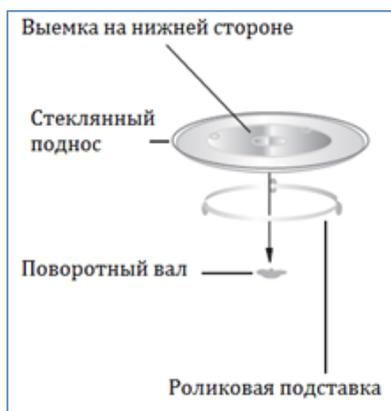
На поворотную ось устанавливается стеклянный поднос. Под стеклянный поднос устанавливается роликовая подставка, которая помогает подносу свободно вращаться. Вращение пищи во время работы печи способствует ее равномерному приготовлению.
