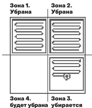
В начале уборки робот-пылесос сканирует комнату и генерирует карту с разделением комнаты на зоны. При зонировании комнаты пылесос сначала убирает пол вдоль стен, затем планирует дальнейший
