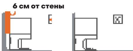
Желательно, чтобы док-станция имела постоянное место в течение длительного времени. Не следует перемещать док-станцию в другое место во время работы пылесоса.
