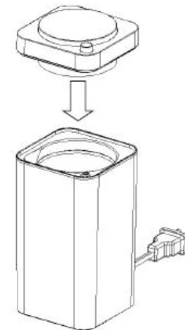
Закройте крышку, повернув ее по часовой стрелке, и подключите вилку сетевого шнура к электрической розетке.
