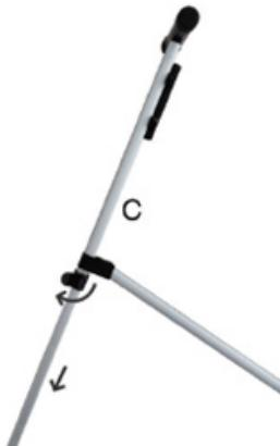
Вставьте телескопические трубы в соответствующие отверстия на корпусе прибора.
