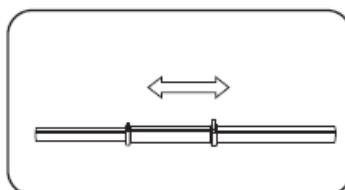
Отрегулируйте высоту телескопических трубок. Для этого ослабьте фиксаторы, отрегулируйте высоту и снова закрепите фиксаторы. Убедитесь, что трубы имеют одинаковую высоту. Для гладжки одежды рекомендуется устанавливать максимальную высоту трубок.
