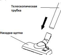
4. Установите на трубку подходящую насадку.
