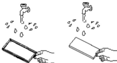
Промойте фильтр и держатель прохладной водой под краном.
