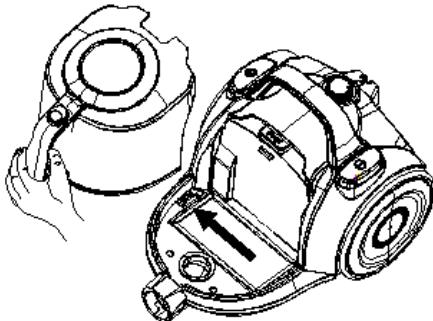
Затем установите фильтр обратно внутрь пылесоса (направление установки фильтра обозначено на рисунке стрелкой).
