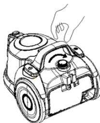
3. Выполните уборку. Вы можете изменять мощность всасывания, вращая регулятор на корпусе. Кроме того, вы можете быстро изменять силу всасывания, открывая или закрывая воздушную заслонку на ручке.
