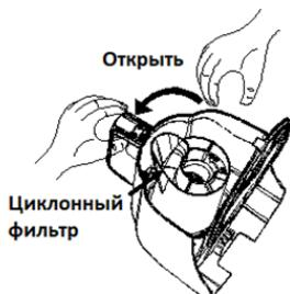
Снимите контейнер для сбора пыли. Откройте верхнюю крышку контейнера. Поверните циклонный фильтр против часовой стрелки и извлеките из контейнера.
